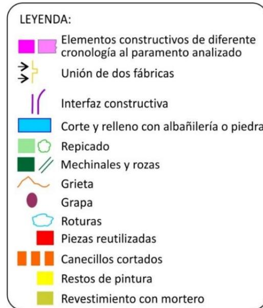
Figura 1. Códigos de color para identificar las acciones constructivo-destructivas
